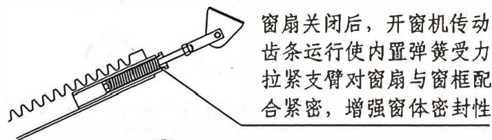
A 齿条保护机构
